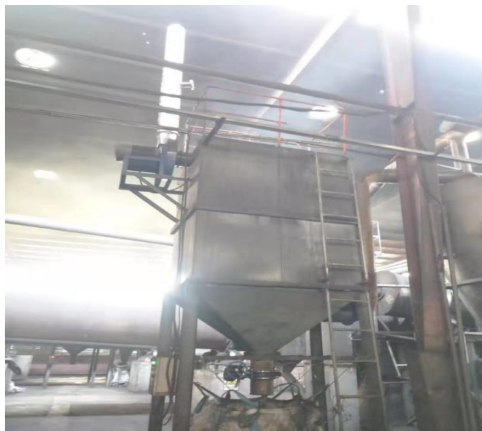
图 4-7 炭化工序下料布袋除尘器
