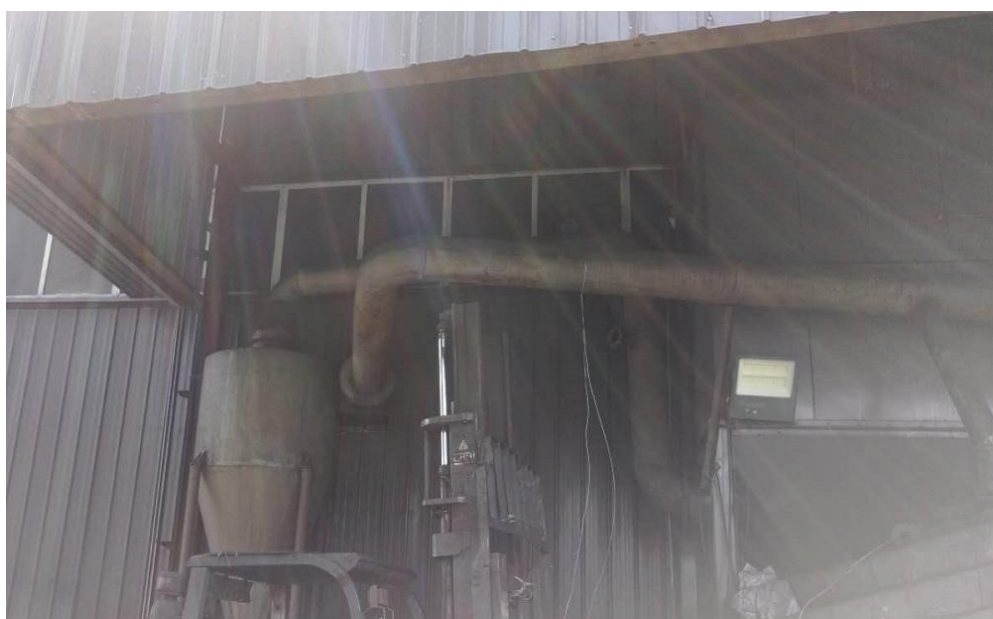
图 4-8 炭化筛分旋风除尘器及布袋除尘器
