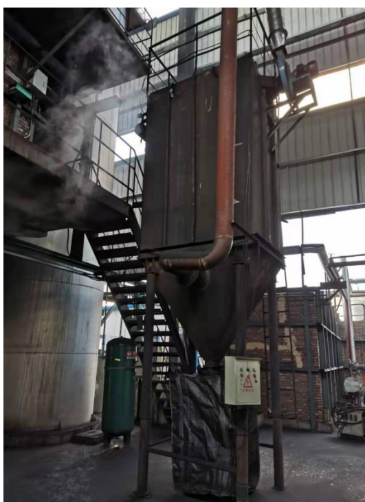
图 4-11 活化工序下料布袋除尘器
